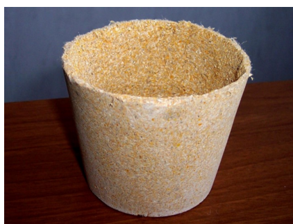
Foto 8. Vasetto ottenuto con scarti di canapa prodotti a seguito della stigliatura delle bacchette di canapa
