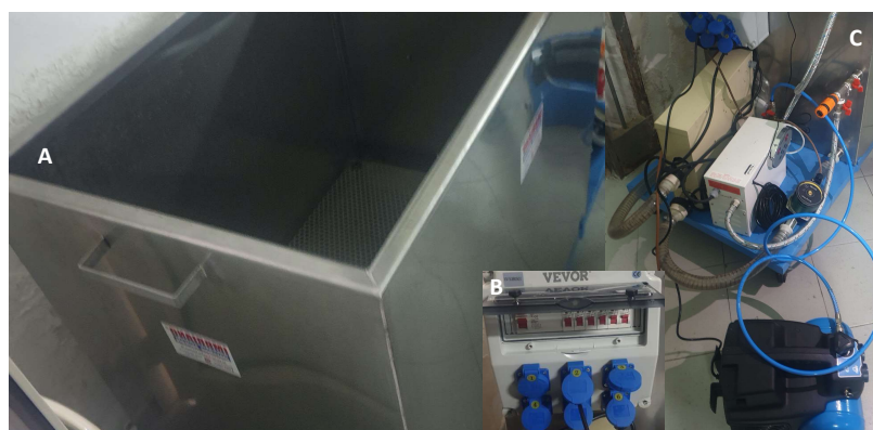
Figura 6. Prototipo della vasca di macerazione da 500 litri (A); pannello di controllo (B); caldaia, resistenza e compressore (C).
